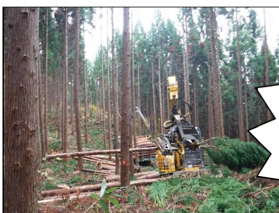
伐木造材機(ハーベスタ)で丸太を作る作業
